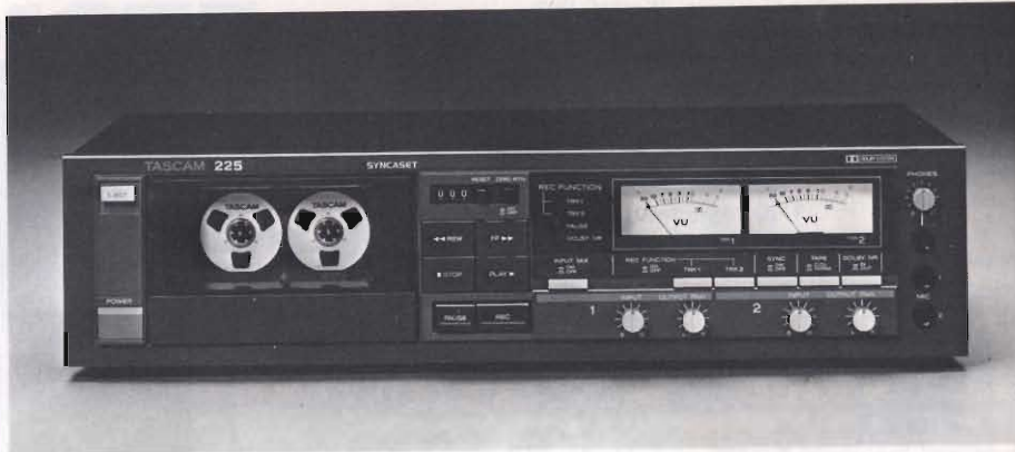
Fig. 4 - Il TASCAM 225 Syncaset, registratore "creativo" a cassetta, 4 tracce/2 canali con velocità di 4,8 cm/sec.
