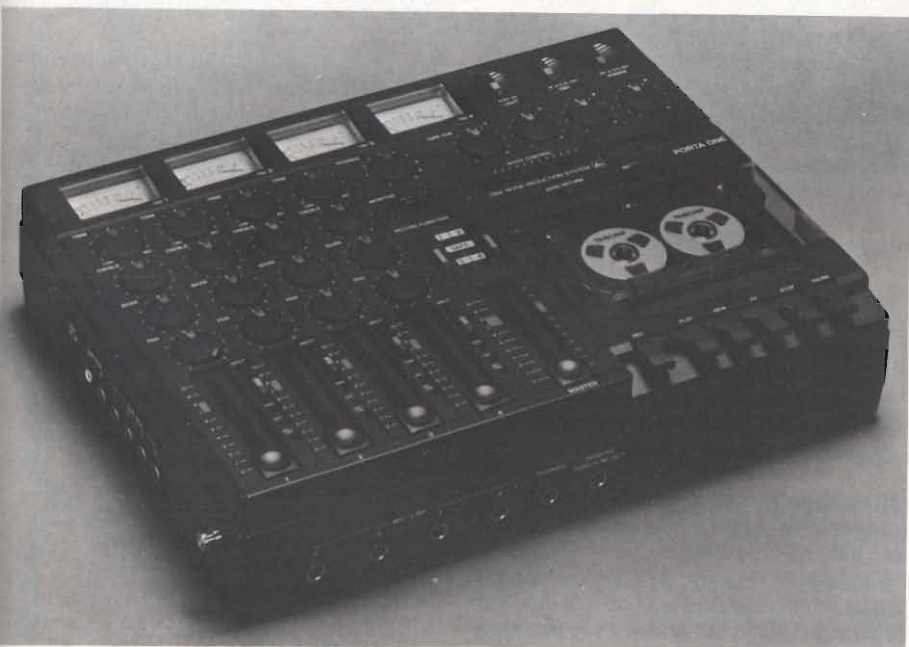
Fig. 7 - Il TASCAM "ministudio" è il fratello minore del TASCAM 224 "portastudio". Simile al fratello maggiore nelle funzioni, ne rappresenta una versione più economica e compatta. Gira alla velocità standard di 4,8 cm/sec.
